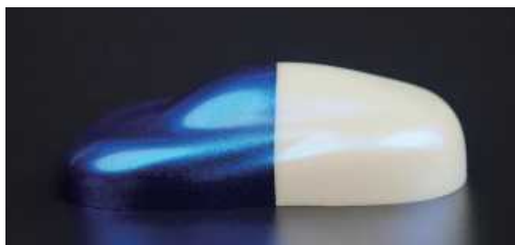
型号 Grade: XY-TX606 粒径 Particle size: 38-45μm 颜色 Colour: 天蓝变蓝 Sky Blue/Blue
